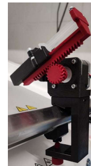
Rys. 1 Dozownik traseru przymocowany do platformy reaktora
